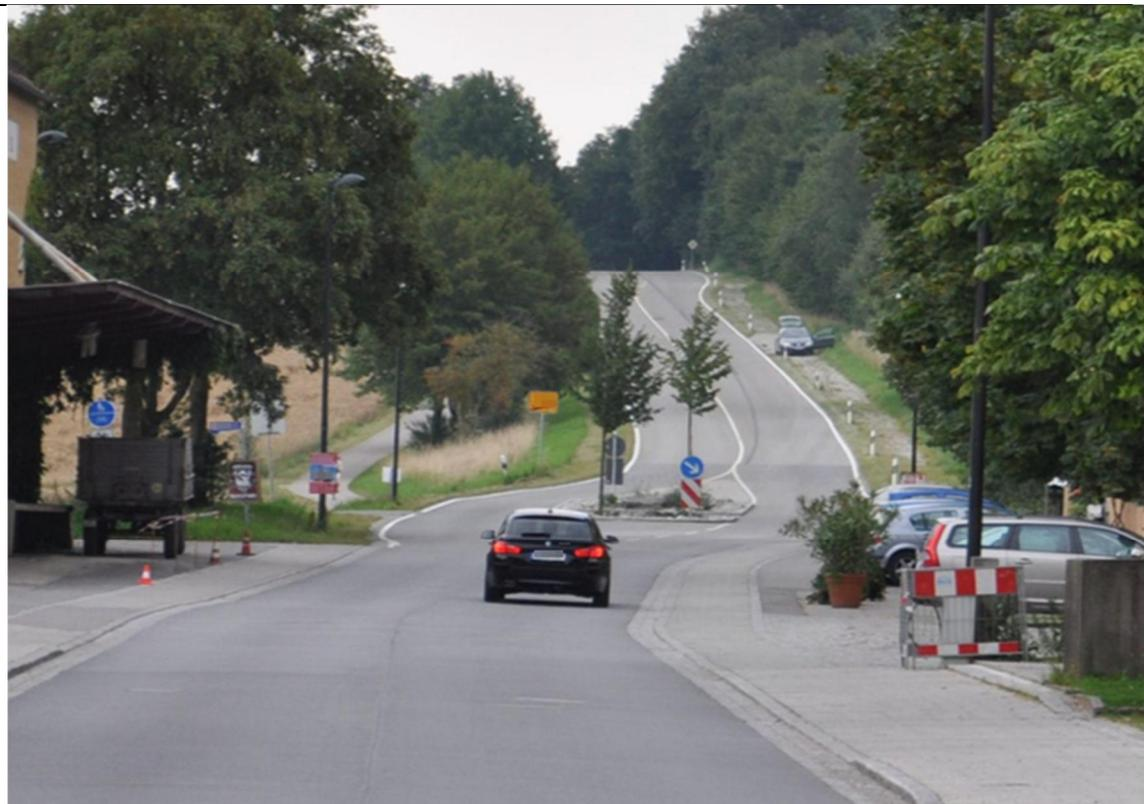
Abbildung 14: Beispiel für Verkehrsinsel mit Fahrbahnverschwenkung
